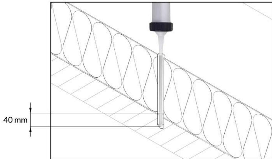
Bohrloch 40 mm mit Montagemörtel auffüllen.
