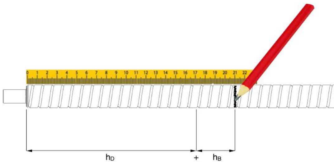
Auf dem Glasfaseranker Dicke der Dämmstärke  $h_D + 40\text{mm}$  Bohrlochtiefe in Betondecke  $h_B$  anzeichnen.
