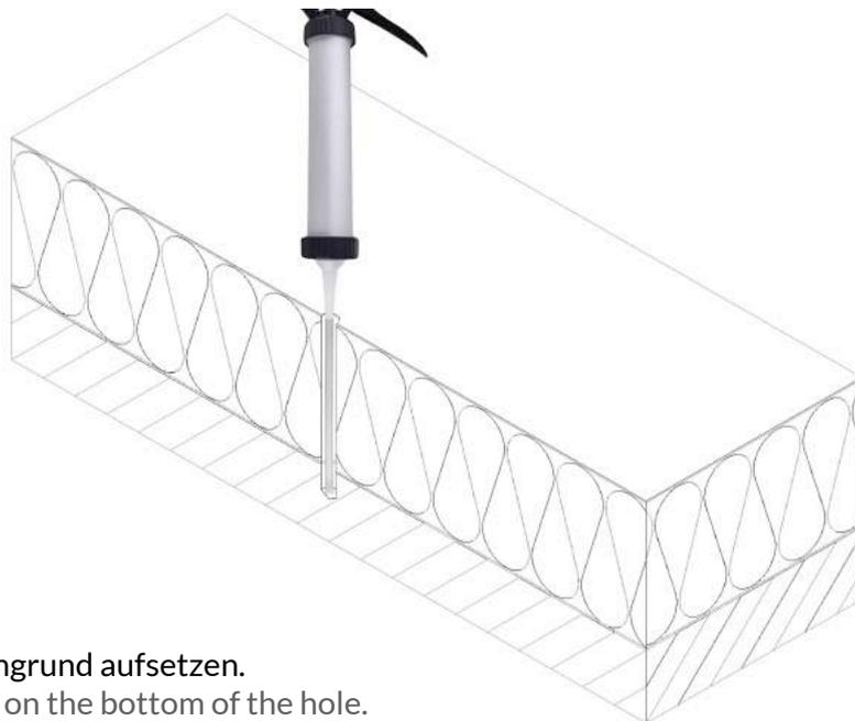
Mischdüse auf Bohrlochgrund aufsetzen.
