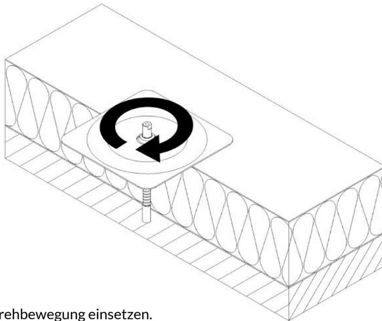
Dachkonsole in einer Drehbewegung einsetzen.
