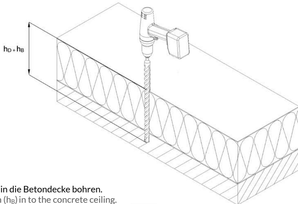
40 mm ( $h_B$ ) in die Betondecke bohren.
